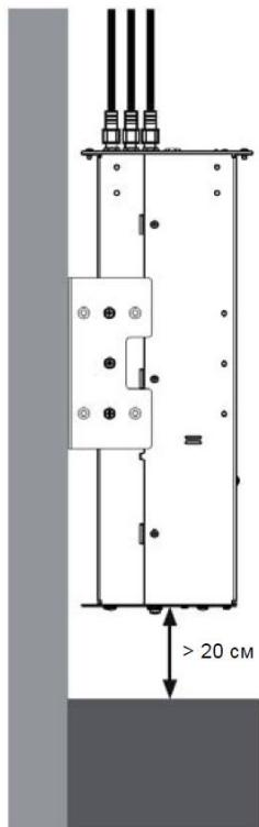
Если кабели подводятся снизу базового блока, выберите этот вариант настенной установки. Соблюдайте минимальный радиус изгиба коаксиального кабеля.
