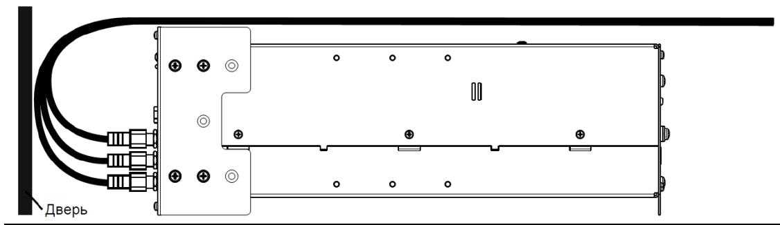
Установка с учетом большего радиуса изгиба соединительных кабелей (использовать задние отверстия на кронштейнах)
